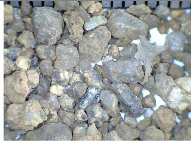
Abbildung 54 SD 2 Bachsediment, braun, > 1 bis < 4 mm, kantengerundet, Granit, Quarz, Feldspat, wenig Glimmer, kaum dunkle Schwerminerale
