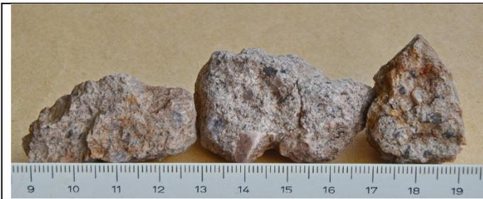
Abbildung 37 RS 1 Mittelboden Klufkörperkerne aus dem Granitzersatz
