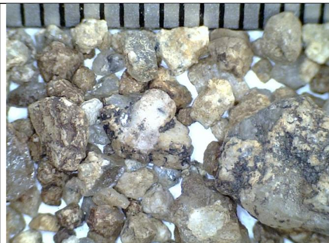
Abbildung 58 SD 3 Bachsediment, braun, > 1 bis < 4 mm, kantengerundet, Granit, Quarz, Feldspat, wenig Glimmer, ohne dunkle Schwerminerale
