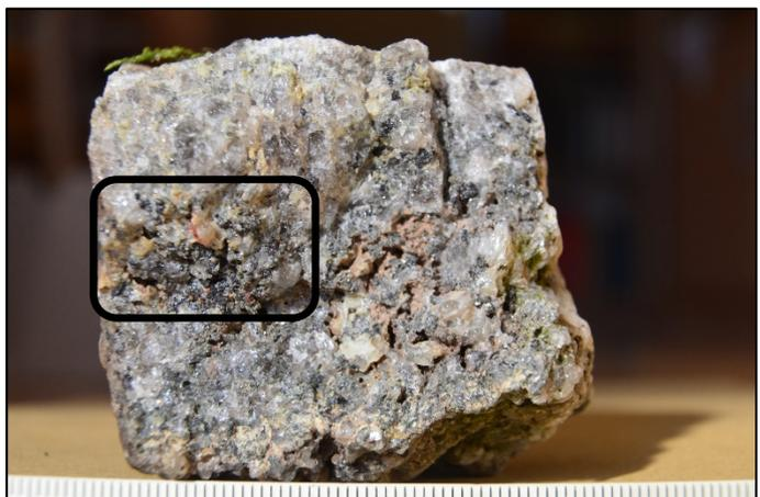
Abbildung 13 Erosionsteilfläche A, Greisenstück Probe 2 aus einer offen liegenden Schotterbank, aufgeschlagen, um 1 mm große Zinnsteinkörner an einer Stelle angereichert
