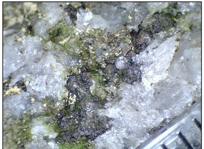
Abbildung 17 Erosionsteilfläche A, Greisenstück Probe 3 aus einer offen liegenden Schotterbank, äußere Seite mit 1-2 mm großen Zinnsteinkörnern, die für die Seifner erkennbar waren.
