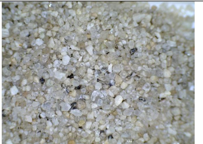
Abbildung 41 RS 1 Unterboden Granitzersatz, grau, < 0,5 mm ausgewaschen mit eckigen, dunklen unmagnetischen Schwermineralen (Kassiterit) 0,1 bis 0,2 mm im Quarz/Feldspat-Korngemisch
