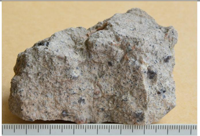
Abbildung 39 RS 1 Unterboden Klufkörperkern aus dem Granitzersatz
