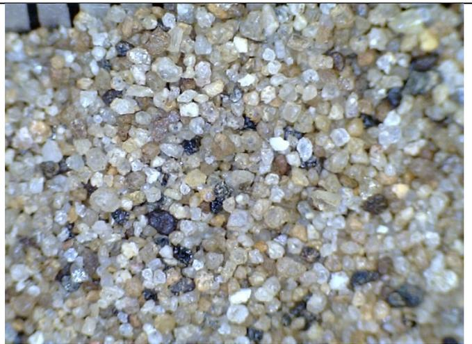
Abbildung 49 M 1 Bachsediment, grau, < 0,5 mm, ausgewaschen mit kantengerundeten, dunklen Schwermineralen bis 0,5 mm, eckiger Quarz, sehr wenig Feldspat, einige kantengerundet
