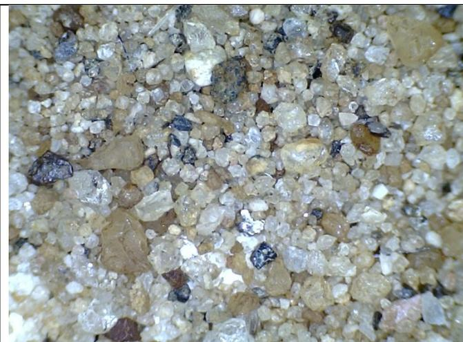
Abbildung 46 W 1 Bachsediment, grau, > 0,5 mm, ausgewaschen mit wenigen kantengerundeten, wenige dunkle Schwermineralen bis 1 mm, eckiger Quarz, sehr wenig Feldspat, einige kantengerundet
